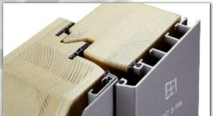
Der patentierte Keilfalz verhindert, dass die Tür nach innen gedrückt werden kann.
